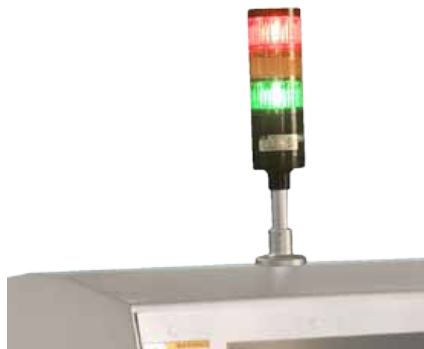
Ilustracja 10: Lampy sygnalizacyjne umieszczone w widocznym miejscu.
