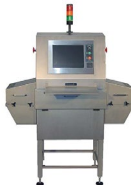
Ilustracja 9: Obudowa aparatu rentgenowskiego wykonana ze stali nierdzewnej
